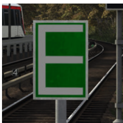
Ende der Langsamfahrstelle
