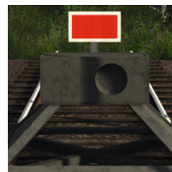
Gleis ist gesperrt
